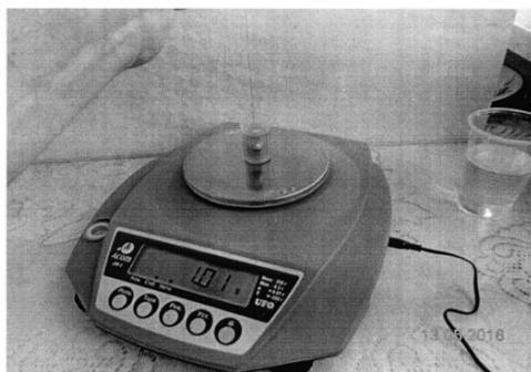
Прямой замер плотности исследуемой жидкости в г /см<sup>3</sup>. Шарик погружен на тонкой нити в сосуд с исследуемой жидкостью, плотность которой по
